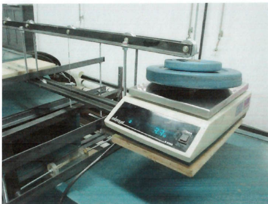
Fig. 4.7.2.7 – Vista aproximada da configuração para a calibração e medição da força de sustentação
