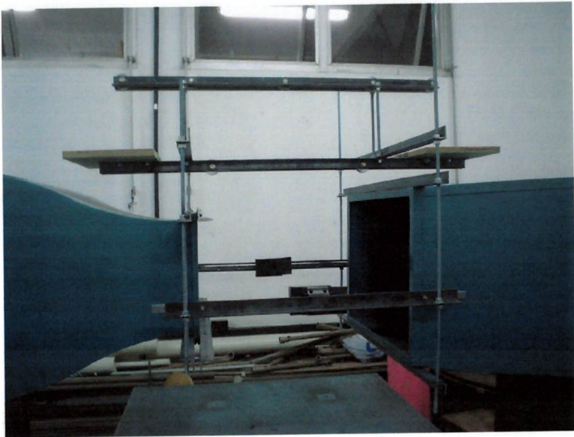
Fig. 4.5.2.7 – Vista lateral da balança, com as guias horizontais montadas
