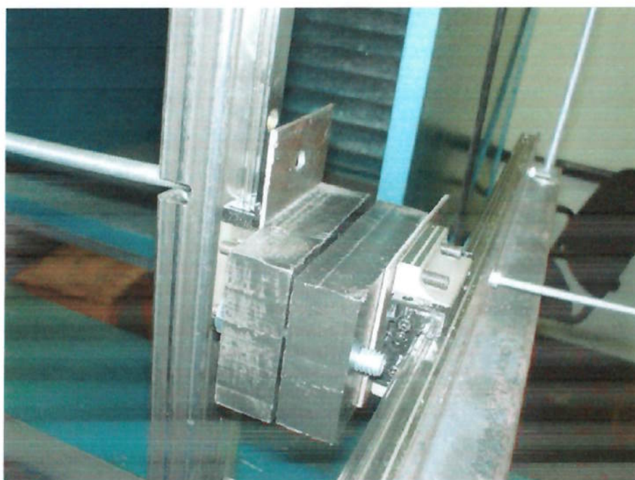
Fig. 4.7.2.8 - Configuração do freio para a calibração e medição da força de sustentação
