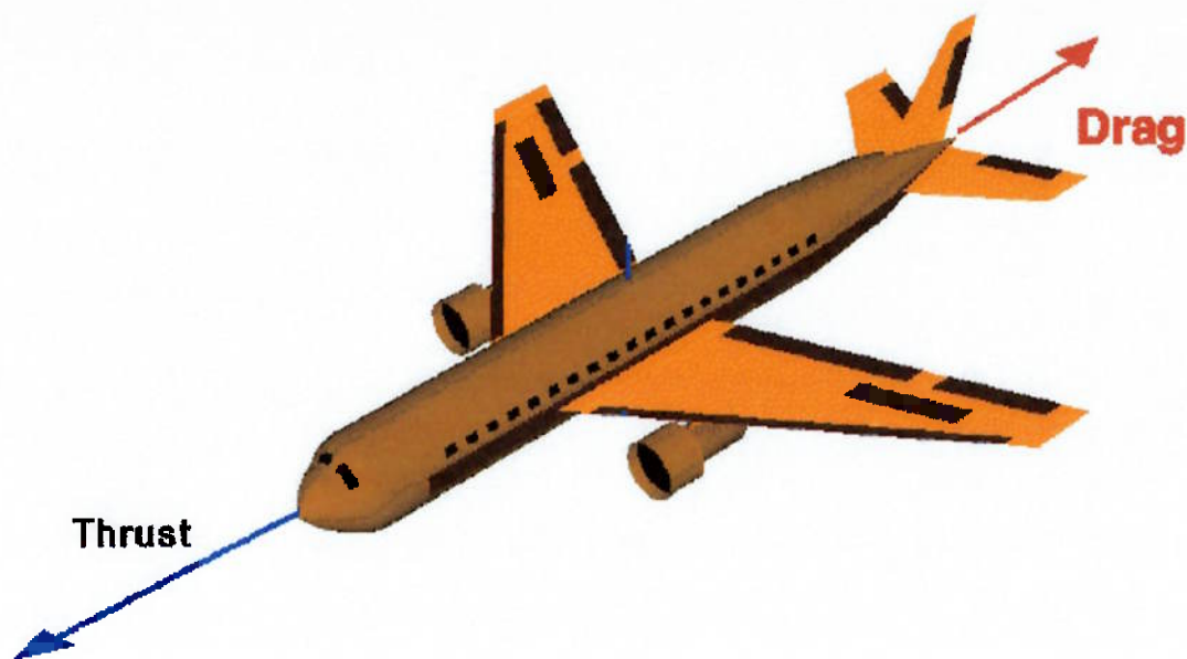
Fig. 2.1.2.1 – Força de arrasto e empuxo presentes em um modelo submetido ao escoamento
