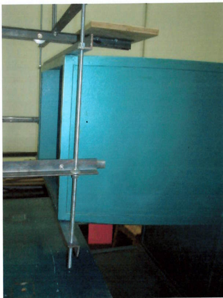
Fig. 4.5.2.2 – Cantoneiras e barras roscadas instaladas
