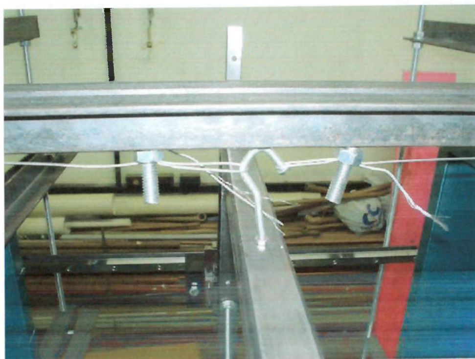
Fig. 4.7.2.2 – Detalhe do gancho do quadro preso aos dois cabos de aço
