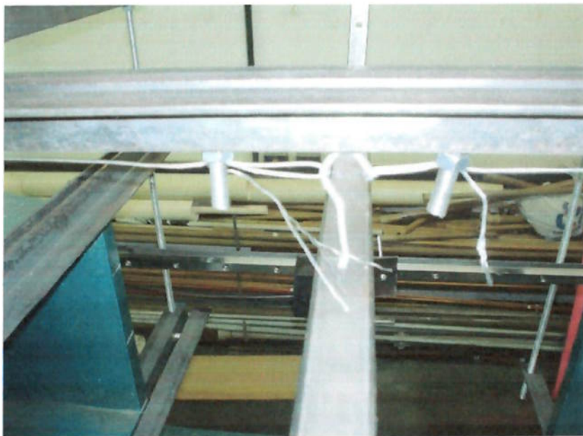
Fig. 4.7.2.10 – Detalhe do gancho do quadro preso aos cabos de aço
