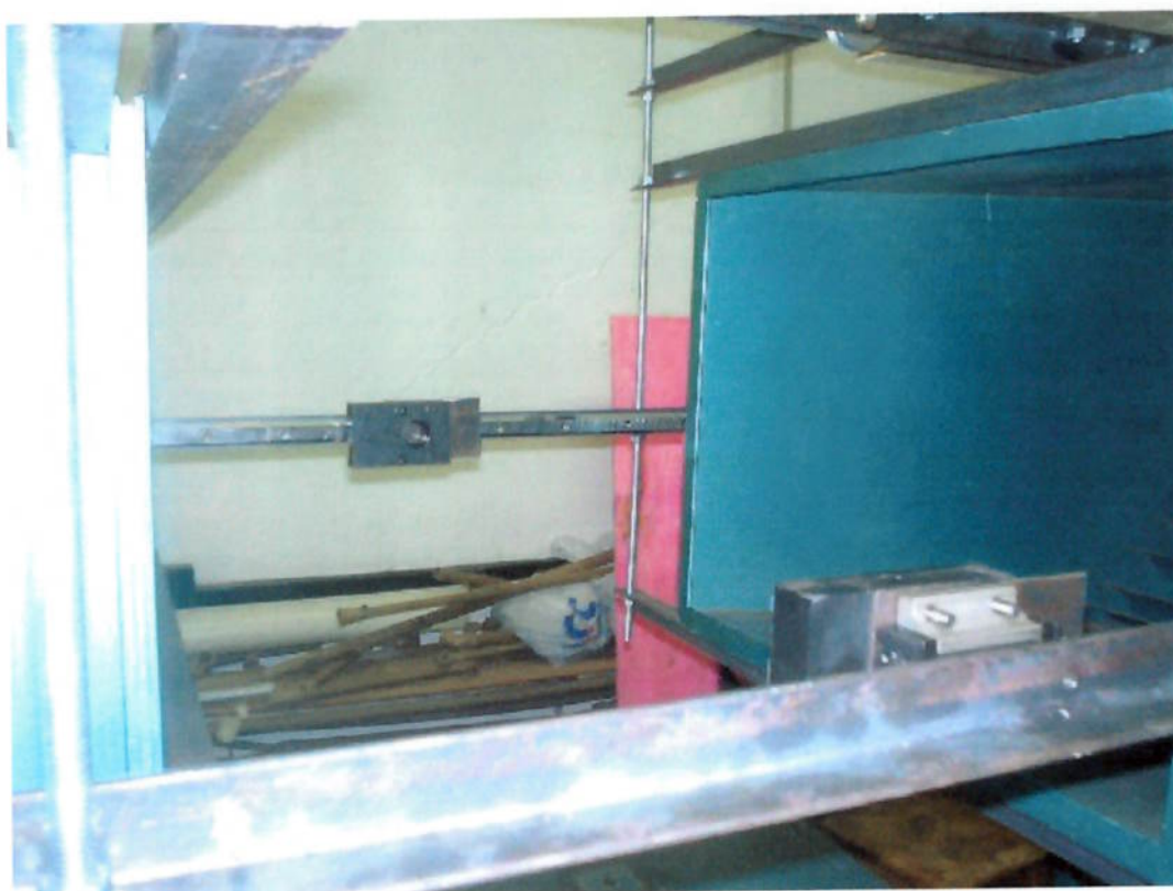
Fig. 4.5.2.6 – Guias lineares horizontais montadas, com as fêmeas dos conjuntos de junção e as chapas de freio da força de arrasto
