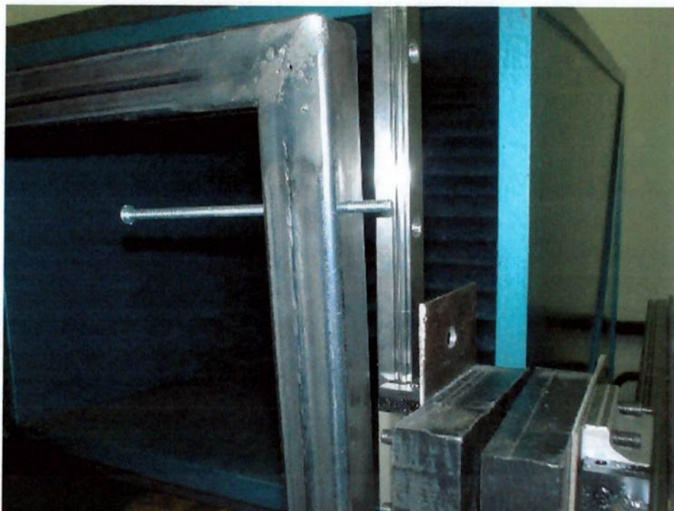
Fig. 4.5.2.18 – Montagem do quadro numa guia vertical com parafuso
