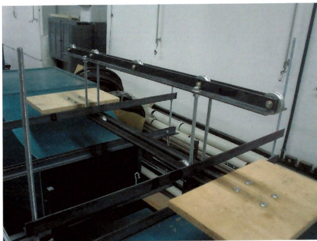
Fig. 4.5.2.4 – Parte superior da balança montada, já com as mesas de apoio
