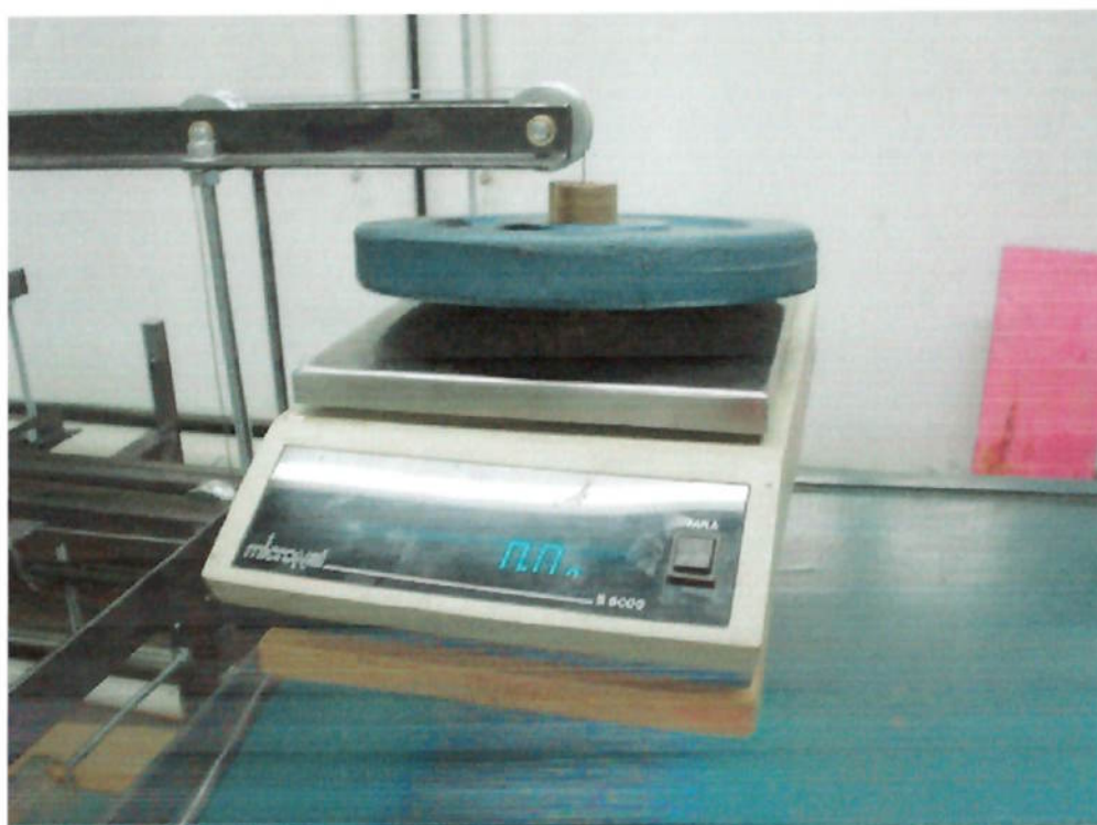
Fig. 4.7.1.3 – Contrapeso de 5 kg sobre a balança digital tarada
