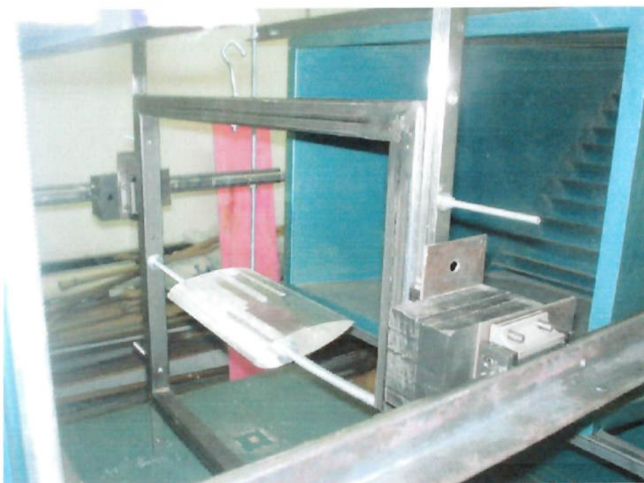
Fig. 4.5.2.33 – Aspecto final do conjunto perfil-barra roscada montado no quadro
